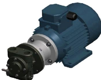
Dans ces cylindrées de motopompes, le standard Pollard est équipé d'un moteur 0,37kW, 4 pôles (1500 tr/min), B34, bride FT85.
